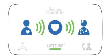
Si los indicadores están encendidos como se muestra arriba, la configuración habrá finalizado. Las luces se apagarán automáticamente después de 2 minutos.
