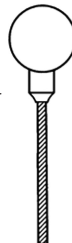
Figura 2-3. Balão de regulação da pressão
