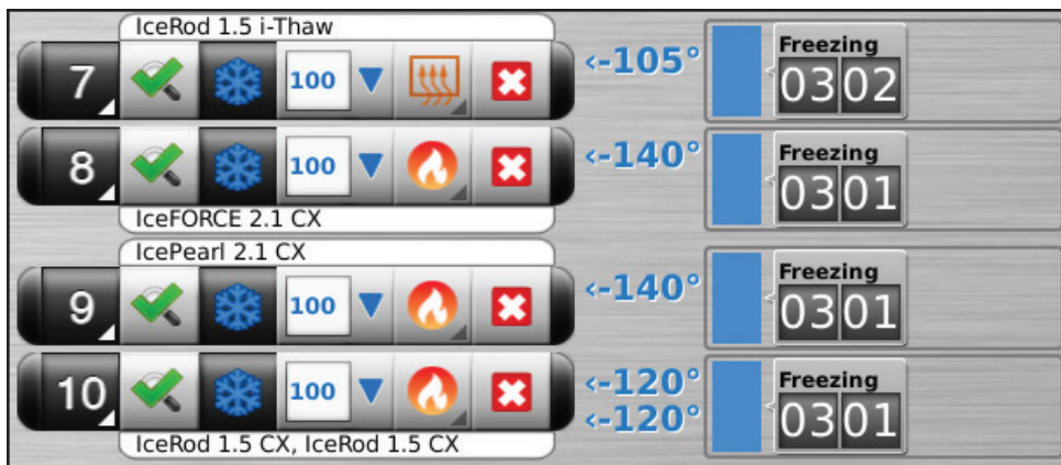
Екран 21. Дисплей за температурата на върха на иглата
