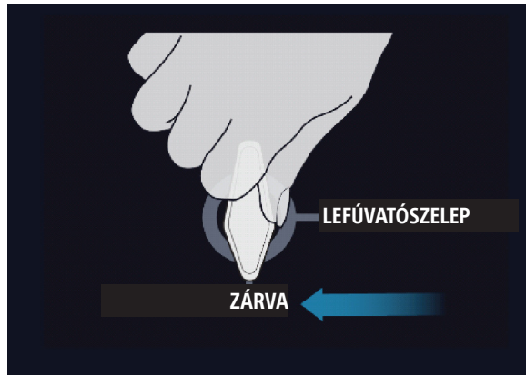
16. ábra: (megegyezik a 8. ábrával) Vent (Lefúvatószelep) – teljesen elzárva
