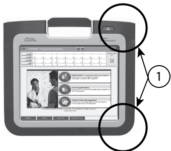
Slika 8. Pogled od spredaj sistema za programiranje LATITUDE s prikazom približnih lokacij antene v ohišju
