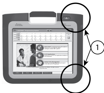
Figura 8. Vista de Frente do Sistema de Programação LATITUDE Indicadora das Localizações Aproximadas da Antena no Invólucro
