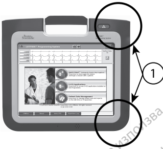
Figura 8. Vista frontal del sistema de programación LATITUDE indicando las ubicaciones aproximadas de la antena dentro de la carcasa.
