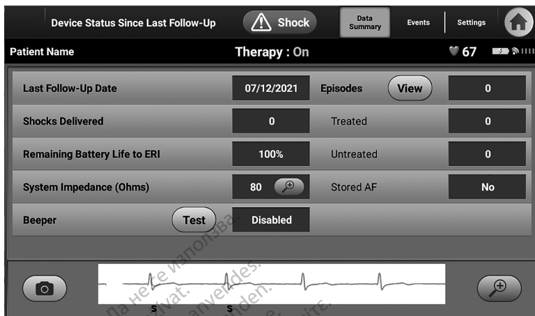
Slika 27. Zaslón Device Status (Status uređaja)
