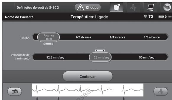
Figura 30. Ajustar Ganho e Velocidade de varrimento
