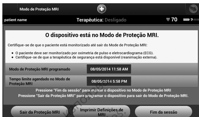
Figura 2-6. Caixa de diálogo Modo do Protecção RM programada com o botão Sair da Protecção MRI
