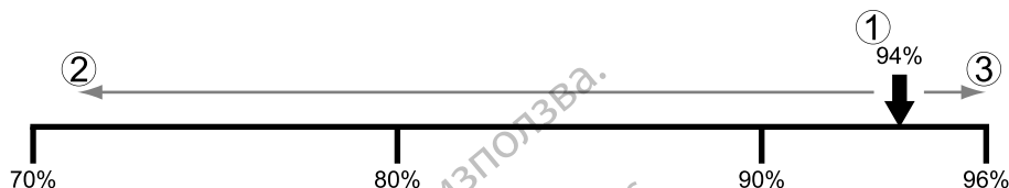
[1] Valor nominal de RhythmMatch Threshold (Limiar de RhythmMatch) [2] Menos sensível a VT, mais específico para SVT [3] Mais sensível a VT, menos específico para SVT
