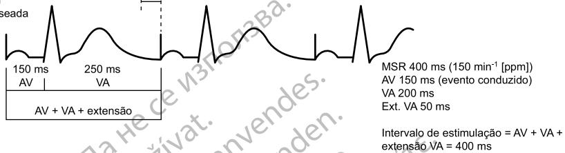
O algoritmo de temporização do gerador de impulsos proporciona uma estimulação eficaz na MSR com condução ventricular intrínseca. A extensão do intervalo VA evita que a estimulação A ultrapasse a MSR nas frequências altas.
