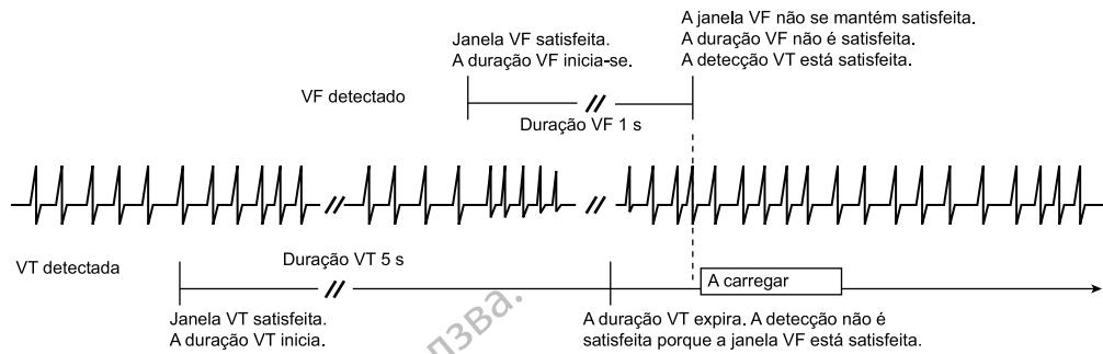
Figura 2-9. Interacção da duração ventricular, configuração de 2 zonas, carga atrasada
