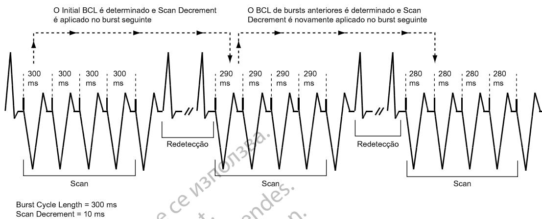
Figura 3-17. Scan scheme, nonadaptive BCL e Scan Decrement programados em On
