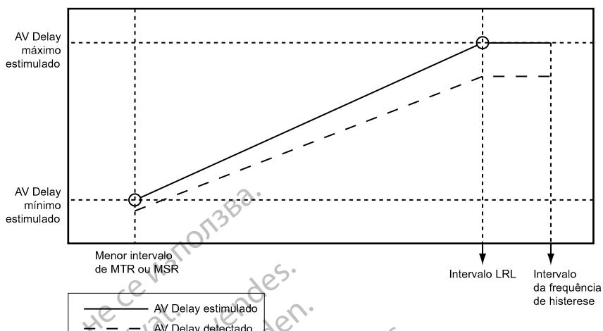
Figura 4-34. Função de intervalo AV detectado e dinâmico
