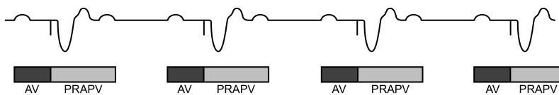
Ilustração do bloqueio 2:1 do pacemaker, em que uma a cada duas ondas P desce no intervalo PRAPV.
