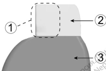
[1] Identificador radiológico [2] Bloco de conectores [3] Caixa do gerador de impulsos
