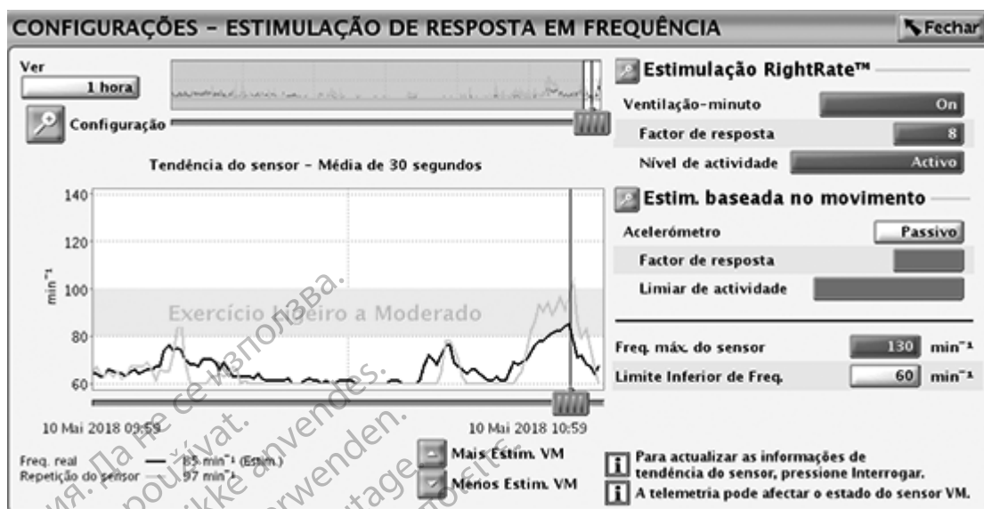
Figura 2-30. Resposta em frequência após o sensor VM ser programado para On
