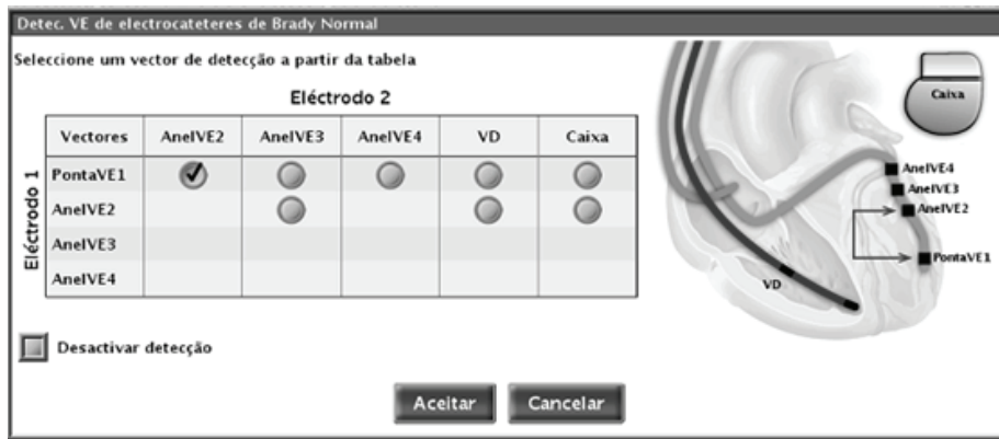
Figura 2-41. Ecrã de configuração do electrocateter de deteção para dispositivos Quadripolares
