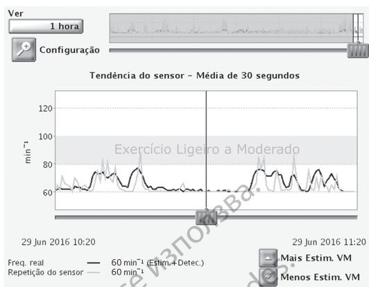
Figura 2-35. Gráfico de tendência do sensor com intervalo de esforço
