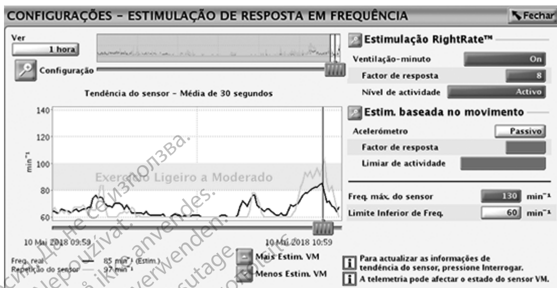
Figura 2–28. Resposta em frequência após o sensor VM ser programado para On
