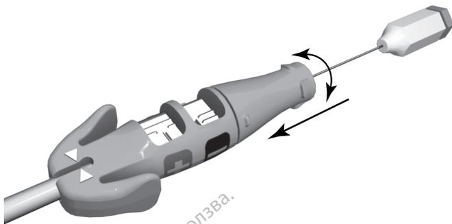
Figura 4. Botão de fixação da ferramenta do conector engatado
