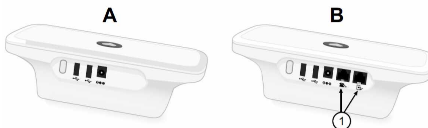
1 標準的なアナログ電話回線接続
