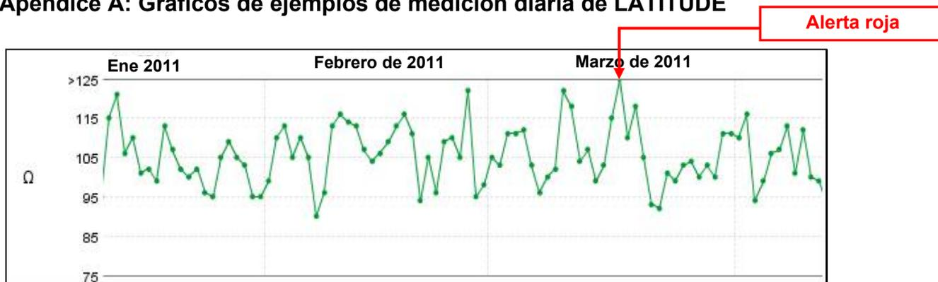
Figura A1. Cable de bobina única normal con impedancia media elevada, que en ocasiones supera los 125 ohms.
