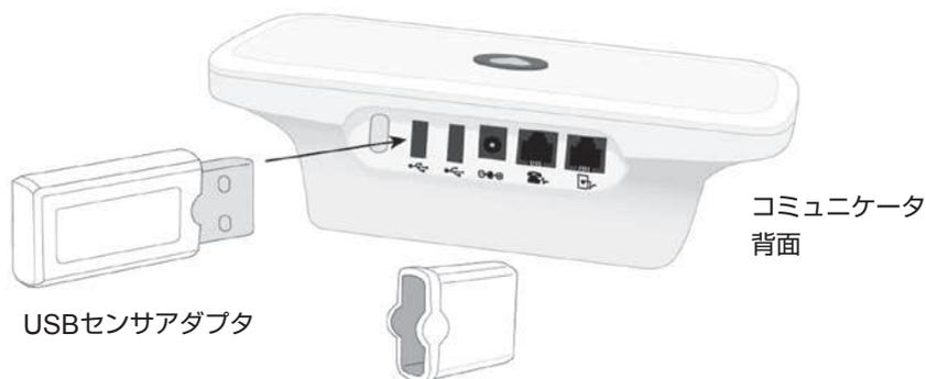
USB センサアダプタは、LATITUDE 体重計・血圧計と一緒に提供されます。USB センサアダプタは、体重計、血圧計の情報を、無線でコミュニケーションユニットに送信します。
